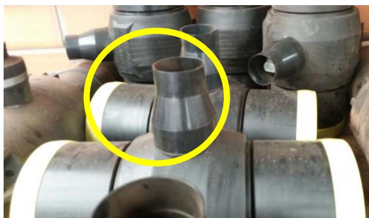
Figura 8 – Válvula com dispositivo para tubo guarda (tulipa).
